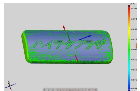
＜設計値照合例＞ （左下：プレートモデル 右下：照合結果）
